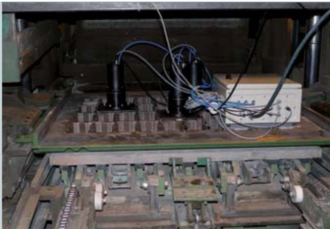
Fig. 12: Vue du dispositif de mesure dans la machine à fabriquer les blocs
