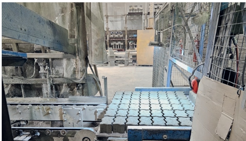
Production de pavés autobloquants de haute qualité sur les planches Wasa Uniplast Ultra
