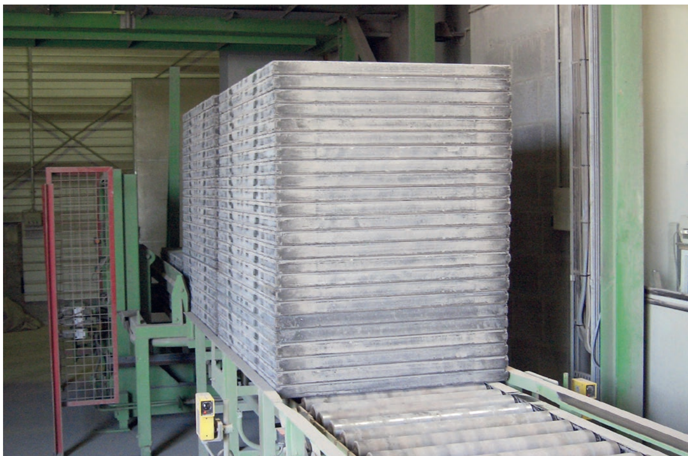
Pile de Wasa Uniplast peu avant l'introduction à la machine
