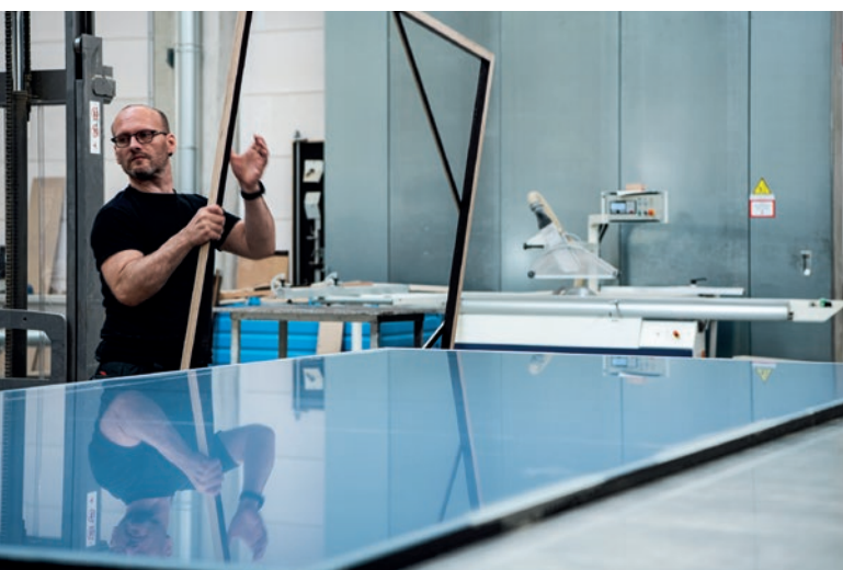
Démontage du moule en silicone 1 : après le séchage du silicone, le cadre est retiré
