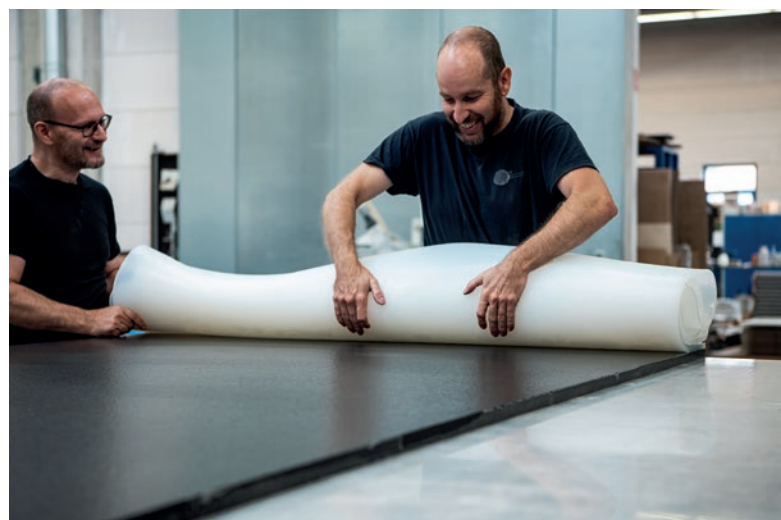
Démontage du moule en silicone 2 : démoulage de la matrice en silicone.
